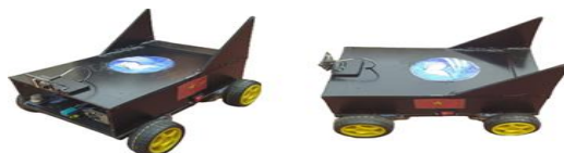
Hình 9: Sản phẩm robot giám sát môi trường trên thực tế
